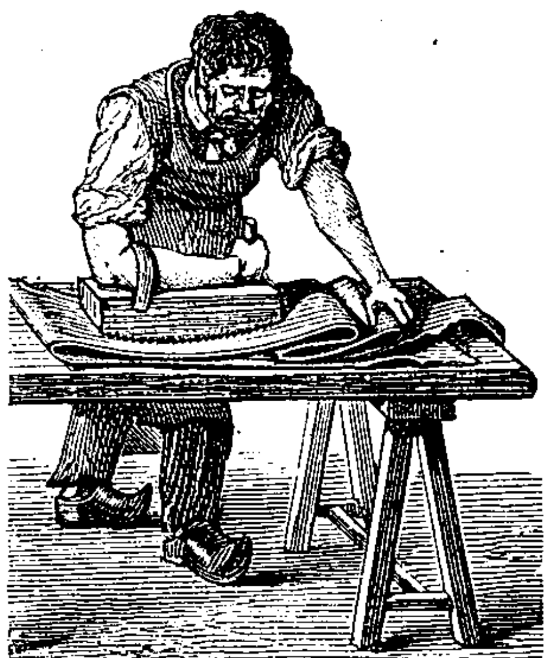
MÉGISSIER TRAVAILLANT A ASSOULIR UNE PEAU. Lorsque le cuir a été tanné et qu'il a subi les premières préparations, il reste à le rendre doux et souple. Pour cela, l'ouvrier l'étend sur une table et le frotte avec un instrument en bois cannelé qu'on nomme marquerite . — On appelle mégissiers les ouvriers qui travaillent les peaux fines, et corroyeurs ceux qui travaillent les peaux plus grossières.
