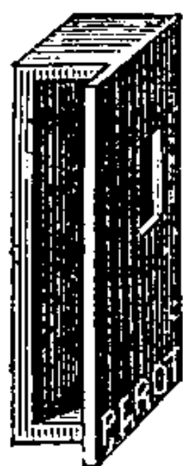
SERRURE APPELEE BEC DE CANE. — C'est la serrure la plus simple. Il suffit pour la fermer de pousser la porte ; le ressort qu'on voit à droite la maintient fermée.
