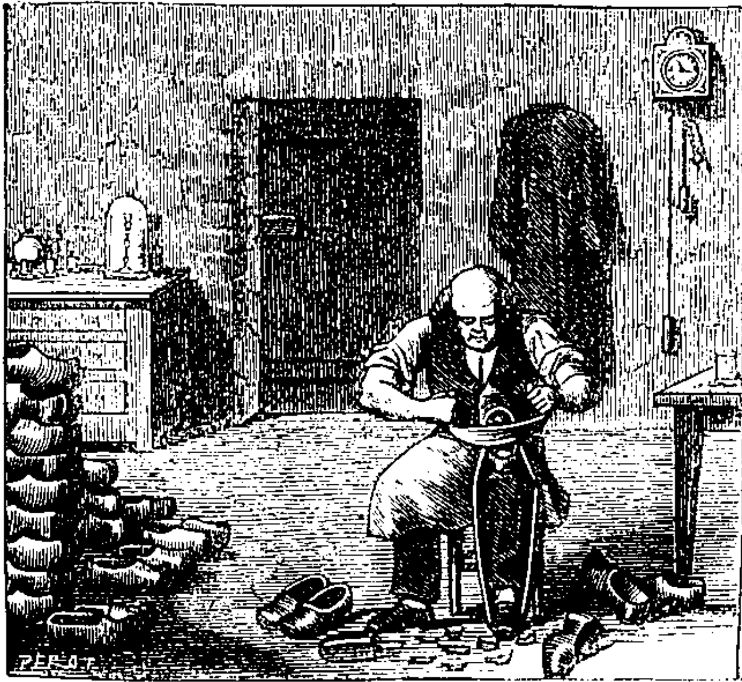
LE SABOTIER DES VOSGES. — On fabrique surtout les sabots dans les pays de forêts et de montagnes, et on se sert principalement de bois de hêtre ou de noyer pour y creuser les sabots. Il y a beaucoup de sabotiers dans les Vosges, car ces montagnes sont très-boisées.
