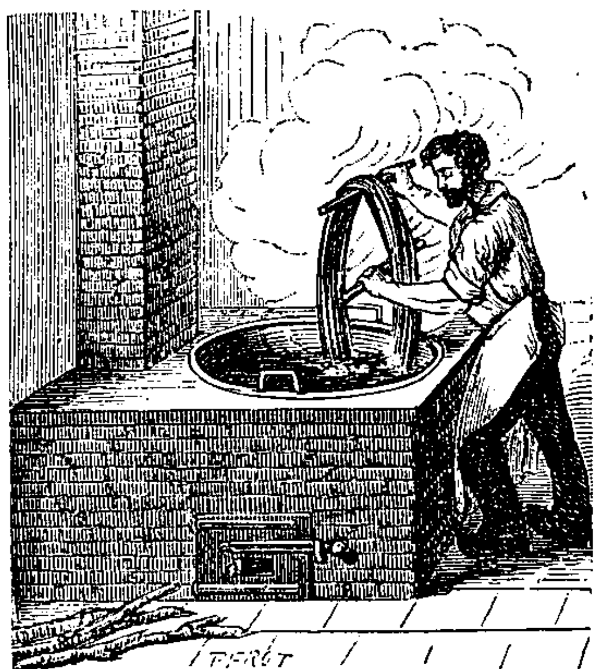
LA TEINTURERIE. — Pour teindre les écheveaux de laine, de coton, de soie, le teinturier les trempe dans un bain colorant, en les tournant et retournant sur des bâtons.
