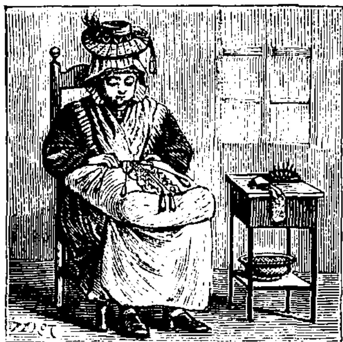
DENTELLIÈRE D'Auvergne. — La dentelle se fait sur un métier portatif, sorte de coussin, au milieu duquel se trouve une petite roue percée de trous qui correspondent au dessin de la dentelle. Les dentellières ont souvent le tort de tenir leur métier sur leurs genoux, au lieu de le placer sur une table ; elles peuvent ainsi devenir contrefaites et même, à la longue, elles s'exposent aux paralysies à cause de la position immobile qu'elles gardent pour ne pas ébranler leur métier.
